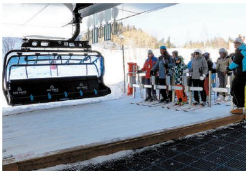
Le nouveau télésiège Pré-Saint-Esprit apporte confort, modernité et fluidité, avec un temps de montée divisé par deux et un débit multiplié par deux. Dans le même temps, le site s'est équipé
